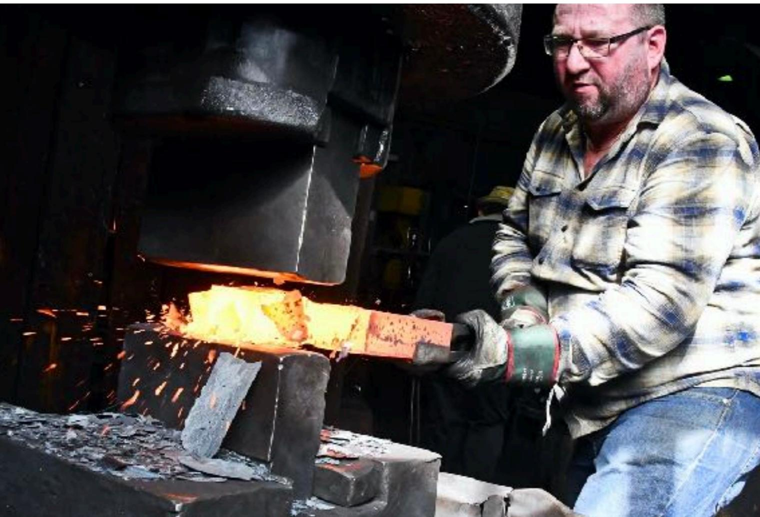
**Werkzeugschmieden** (Brechstangen, ...
