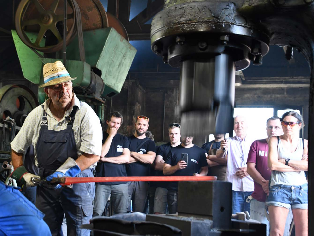
Vorführung-Brechstangenschmieden im Hammerwerk Sonneck Exhibition crowbar forging in the Sonneck hammer
