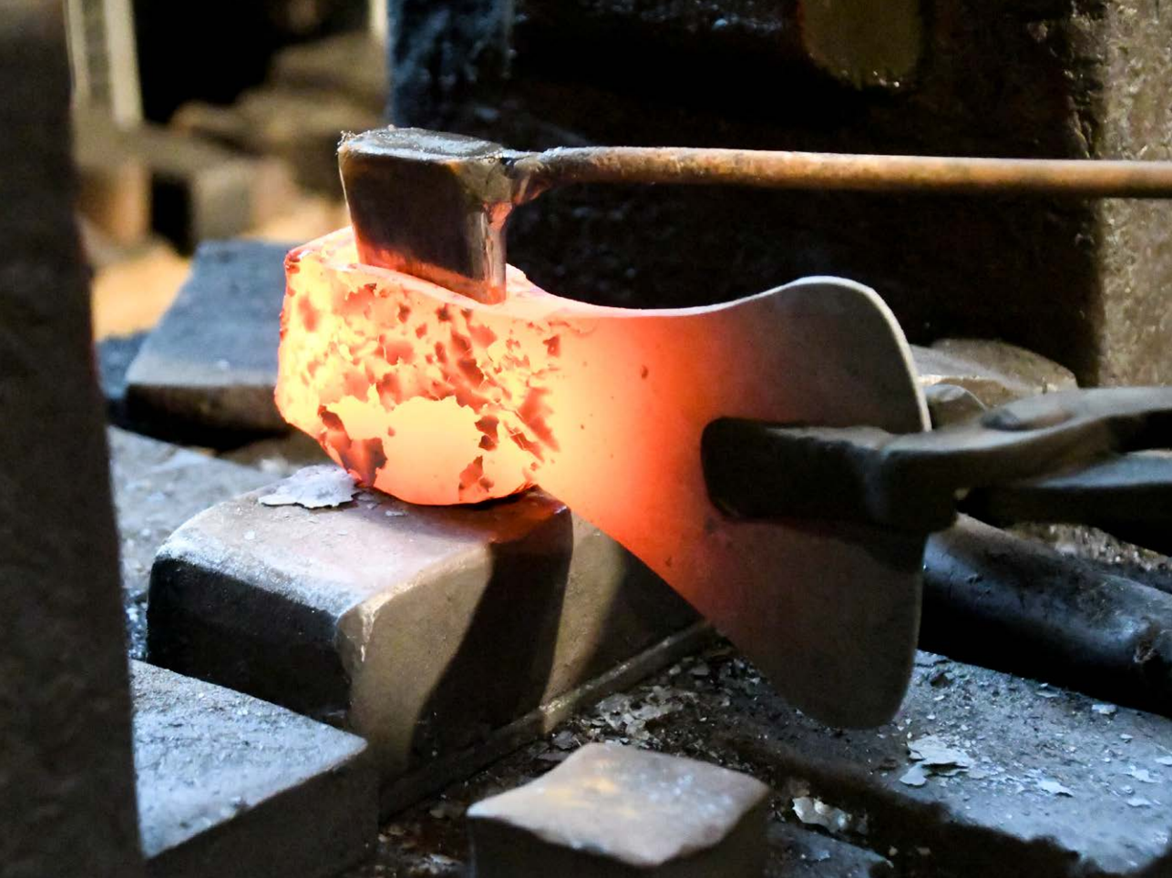
Hackenschmieden in der historischen Schmiede Fahrngruber Axe forging in the historical workshop 'Fahrngruber'
