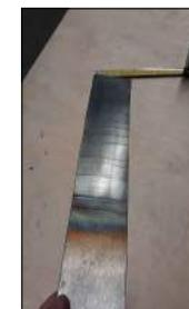
Stirnseite strukturiert, sandgestrahlt und poliert
