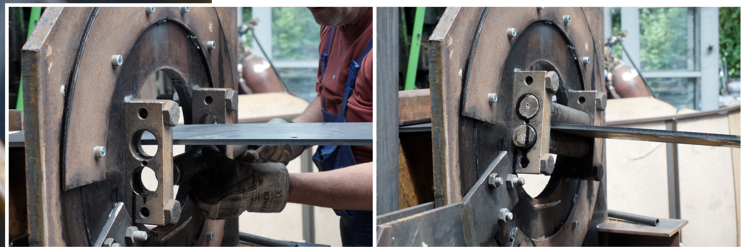
Die Torsionsmaschine von Franz Wahler für das Projekt TöpperPortal gebaut.
